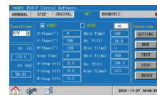
低電壓穿越設置
